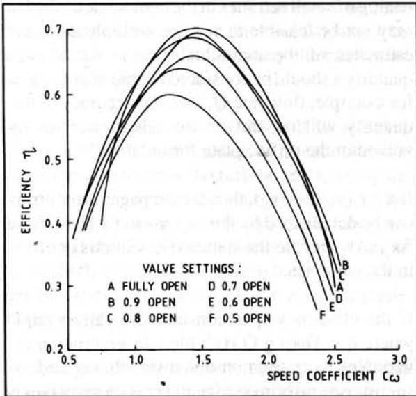
Fig. 3.13:  $\eta$  vs  $c_\omega$
