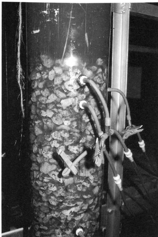
Photo 7 Colonne de préfiltre à gravier vertical
