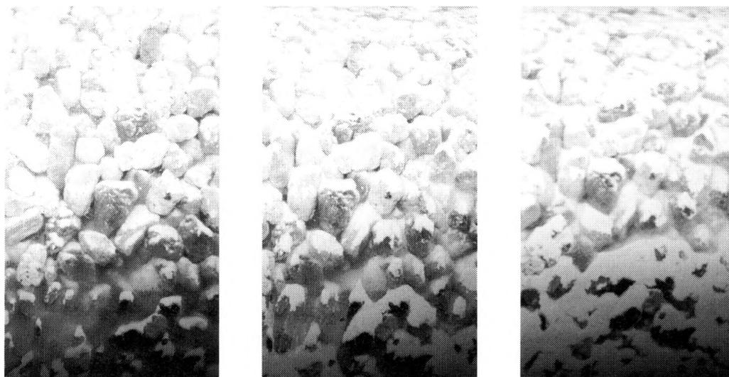
Photo 3 Accumulation de kaolin dans un préfiltre à gravier à flux horizontal après 24 h, 100 h et 300h d'exploitation du filtre
