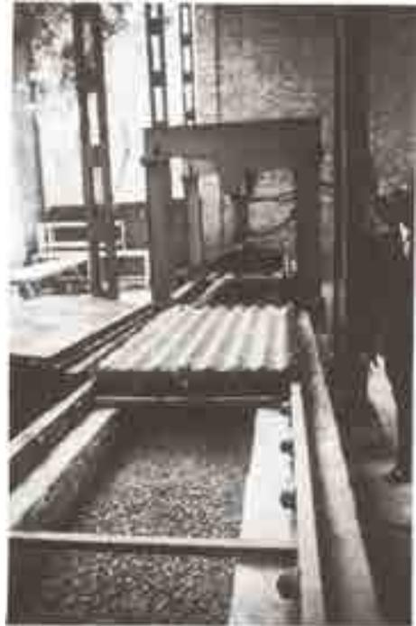
*Presse hydraulique et moule mobile, pour la production de plaques de couverture ondulées en ciment de fibres (fibres de coco ou laine de bois). Selon cette méthode, développée au Central Building Research Institute de Roorkee en Inde, la compression est maintenue sur les plaques moulées pendant la prise du ciment (4 heures), ensuite démoulées, elles sont stockées en position verticale pour la cure (Photo: K. Mukerji).*
