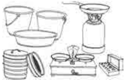
Chaque tamis recueille une certaine quantité de matériau. Le contenu de chaque tamis est séché sur le réchaud ou dans le four et pesé avec précision. Enregistrer les poids. Les fines particules contenues dans le récipient plat sont un mélange de silt et d'argile, qui ne peuvent pas être séparées par tamisage. L'essai suivant permet d'effectuer cette séparation.
