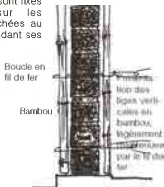
*Ligature de l'ossature en bambou, avec des boucles en fil de fer passées au travers du mur en briques pendant la construction*
