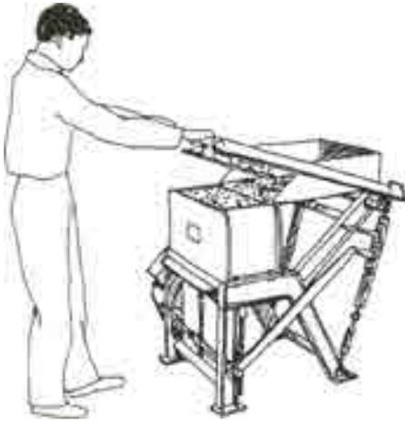
*Machine pouvant produire des blocs en béton pleins ou creux*
