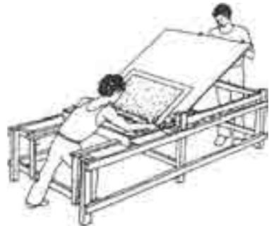
Déplacement de la feuille qui porte la couche de mortier humide sur le moule ondulé emboîtable
