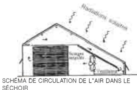
SCHEMA DE CIRCULATION DE L'AIR DANS LE SÉCHOIR
