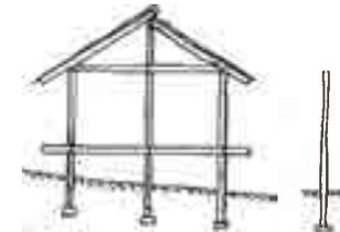
Construction à ossature rigide
