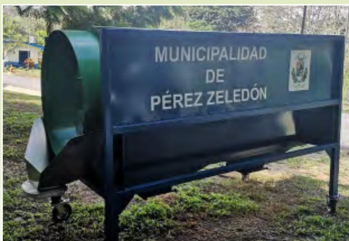
Ilustración 27. Tamizaje en trommel utilizado en la planta de compostaje en Pérez Zeledón
