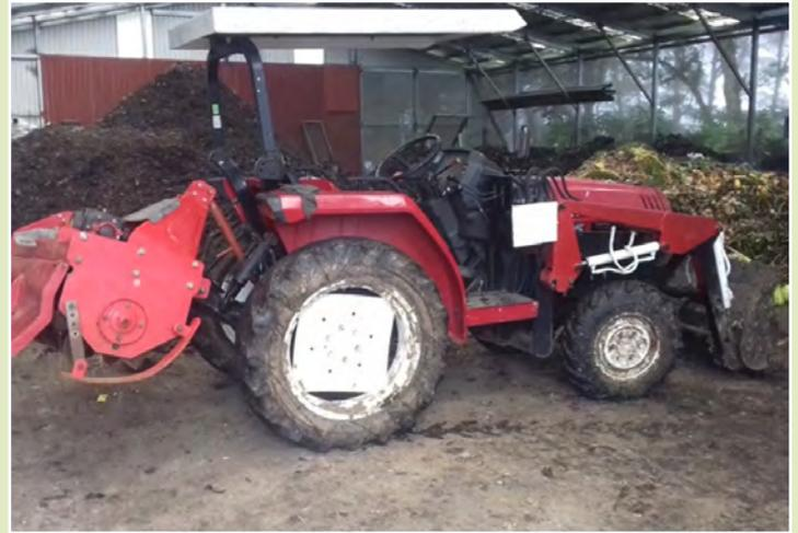
Ilustración 17. Equipo utilizado para el volteo en la planta de compostaje de Alvarado
