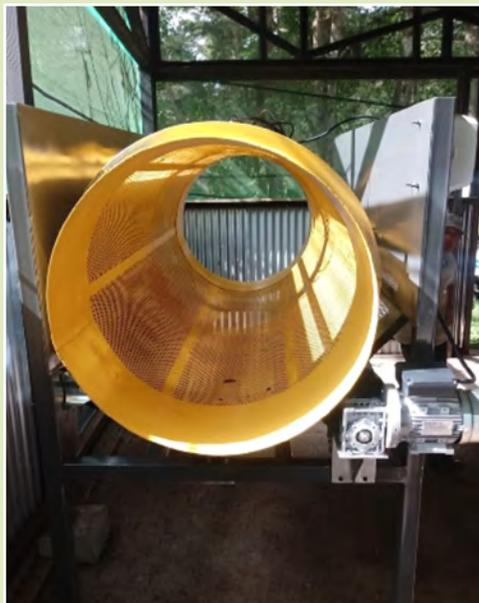
Ilustración 26. Tamizaje en trommel utilizado en la planta de compostaje en San Rafael de Heredia
