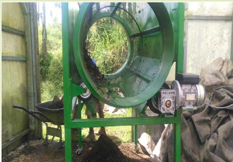
**Ilustración 23. Tamizaje en trommel utilizado en la planta de compostaje en San Isidro de Heredia**
